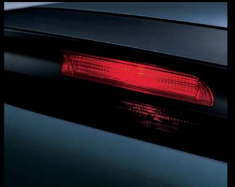
Trzecie światło STOP umieszczone w tylnym spoilerze.
