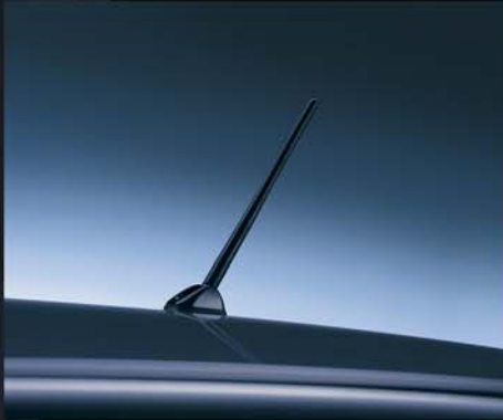
Krótką antena dachowa typu „żądło”.
